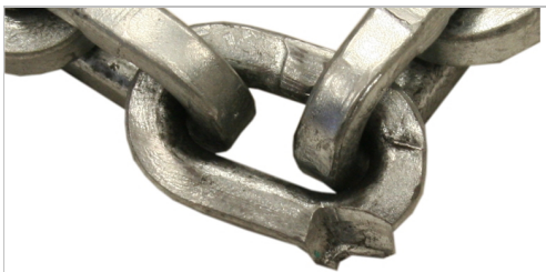
Kædeleddet er mekanisk beskadiget.
